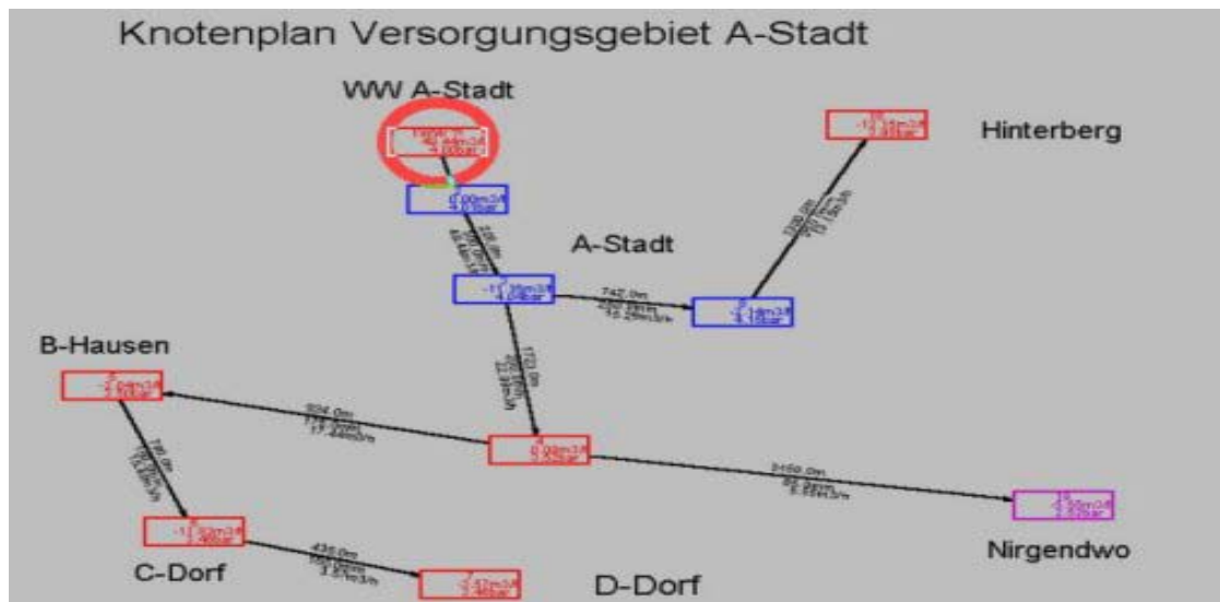
Abb. 2: Knotenplan mit Berechnungsergebnissen an den Knoten und Zusatzinformationen an den Leitungen. Die Druckverhältnisse an den Knoten können farblich abgestuft dargestellt werden
